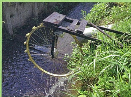
湧き水などが使えるなら自転車水力発電をどうぞ。携帯の充電やLED照明1つくらい、余裕！
